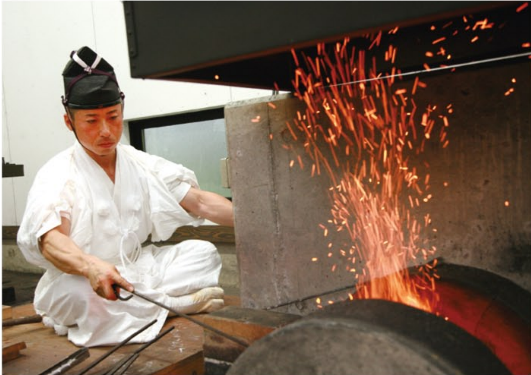
松炭を燃焼させる炉の温度が約1300℃にまで達する工程もある。
